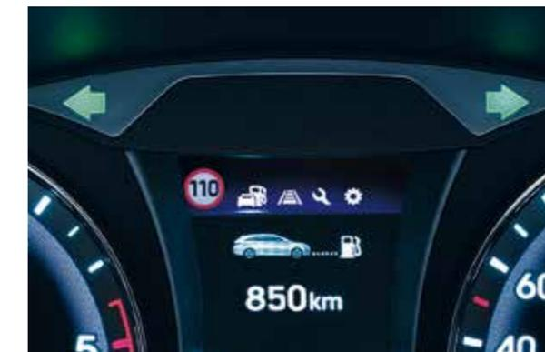
**Speed Limit Identification Function (SLIF).** La funzione di controllo dei limiti di velocità riconosce la segnaletica stradale e visualizza un avviso di limite di velocità sul TFT Cluster SuperVision posto nel cruscotto.
