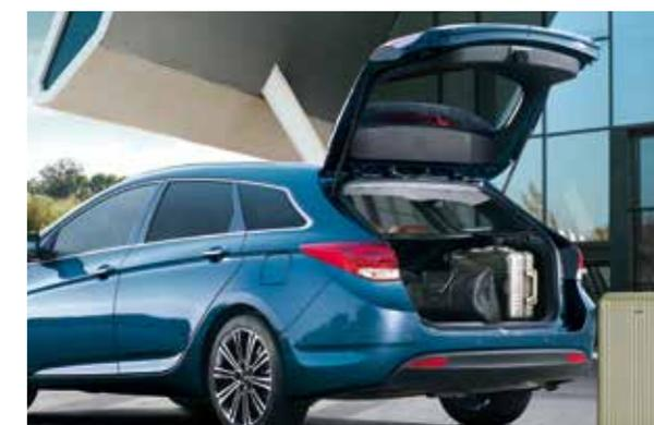
**Portellone posteriore elettrico.** Il portellone posteriore elettrico (di serie su Style) si attiva quando una persona rimane all'interno della zona di rilevamento per almeno 3 secondi. Il sistema riconosce la presenza della chiave e aprirà in automatico il portellone, evitando di appoggiare a terra l'oggetto che deve essere caricato.
