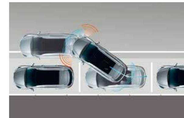
**Smart Parking Assist System (SPAS).** Questo sistema aiuta a parcheggiare con sicurezza anche negli spazi più ristretti. Una volta inserita la retromarcia, i sensori anteriori e posteriori, in combinazione con la retrocamera aiutano il conducente durante le fasi di parcheggio.
