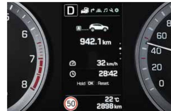
**Informazione sui limiti di velocità (SLIF).** Il sistema riconosce i segnali stradali, li incrocia con i dati di navigazione e mostra il limite di velocità corrente sul display del navigatore e sul display TFT ad alta risoluzione.
