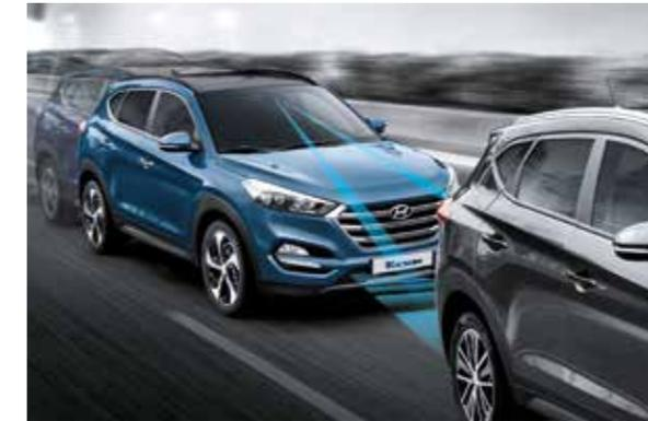
**Sistema di frenata d'emergenza assistita (AEB).** Il radar e la telecamera avvertono il guidatore della prossimità, potenzialmente pericolosa, di veicoli e pedoni, arrivando a frenare autonomamente se necessario.
