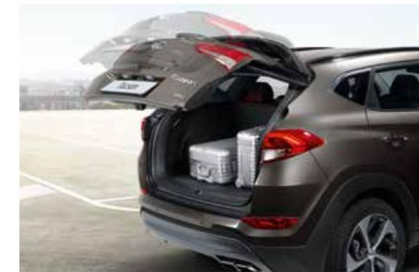
**Portellone elettrico intelligente.** Un sensore rileva l'approssimarsi del possessore della chiave e solleva automaticamente il portellone per consentire l'accesso al generoso spazio di carico senza alcuno sforzo.
