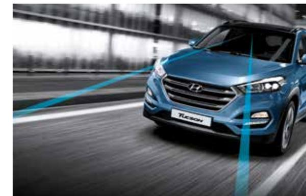
**Sistema di mantenimento della corsia.** Avvisi visivi e acustici, più un'azione correttiva sullo sterzo, sono attivati quando viene rilevato un allontanamento non intenzionale dalla linea di carreggiata.
