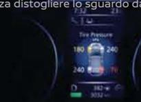
**MONITORAGGIO PRESSIONE PNEUMATICI.** Il display visualizza il livello di pressione degli pneumatici e ti avvisa se la pressione diminuisce.
