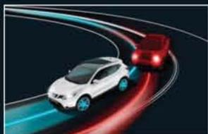
**IL CONTROLLO ATTIVO DELLA TRAIETTORIA** applica una leggera forza frenante sulle ruote interne alla traiettoria, permettendoti di affrontare le curve veloci in completa sicurezza e stabilità.
