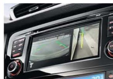
**NIENTE GRAFFI** In fase di marcia e di retromarcia puoi premere il pulsante "camera" per passare dall'immagine dall'alto a quella laterale. Utilissimo per controllare la distanza dalle altre vetture.
