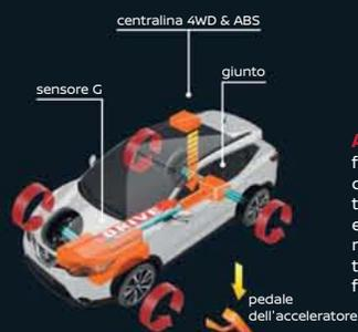
**ALL MODE 4x4-i<sup>+</sup>**: su strada o fuori strada il computer e i sensori del sistema 4x4-i<sup>+</sup> ottimizzano la trazione. Il sistema intelligente rileva eventuali slittamenti delle ruote e ripartisce in automatico la coppia tra asse anteriore e asse posteriore fino ad un massimo di 50/50.
