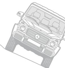
Stabilità di marcia anche in posizione inclinata fino al 54%
