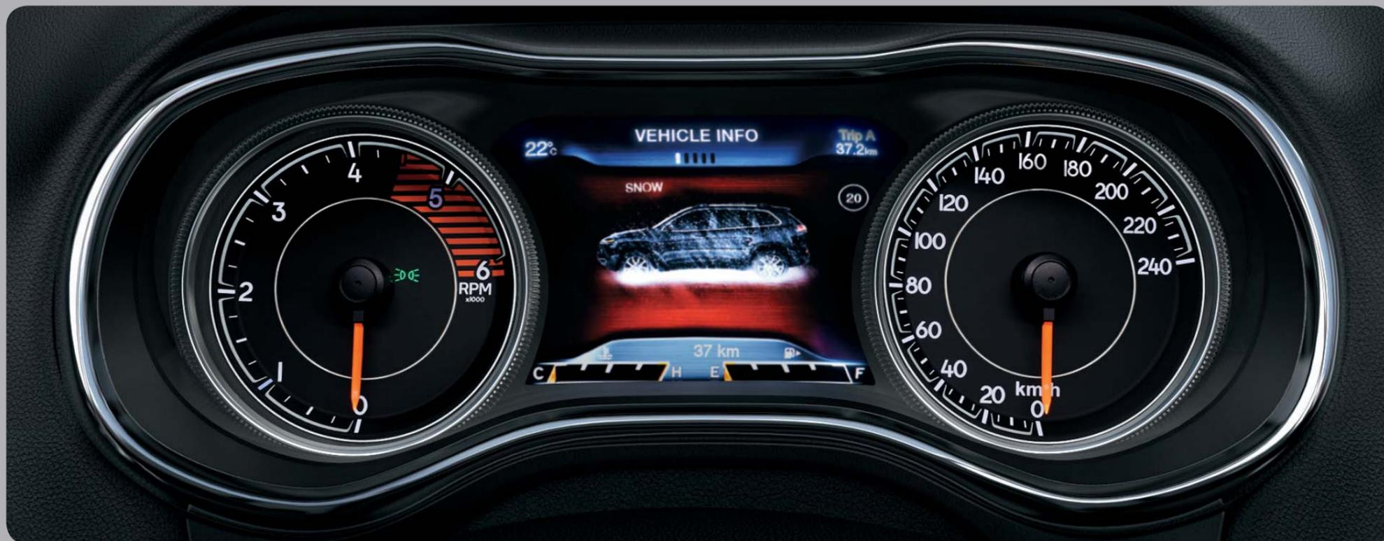
Il quadro strumenti, con schermo LCD da 3,5" sulla versione Longitude e TFT da 7" su Limited e Trailhawk, completamente configurabile dal conducente permette di personalizzare l'esperienza di guida e di ricevere informazioni dalla vettura nel formato preferito. Tutto ciò mantenendo sempre le mani sul volante e lo sguardo sulla strada.
