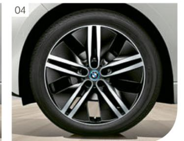
I cerchi in lega leggera della BMW i3 sono particolarmente slanciati per ridurre al massimo la resistenza dell'aria e di rotolamento. Il diametro elevato dei cerchi da 19" e 20" rimarca il carattere agile e sportivo della vettura e contribuisce a ottimizzare la superficie del battistrada. Per evitare inutili vortici
