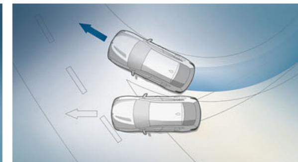
■ **Controllo dinamico di stabilità (DSC):** rileva costantemente lo stato attuale del veicolo e, se necessario, ottimizza la stabilità direzionale e la trazione intervenendo nella gestione del motore e dei freni. Così diventa più semplice dominare la vettura anche in condizioni avverse, aumentando la sicurezza di guida attiva.
