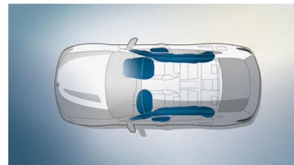
■ **Airbag per guidatore e passeggero:** sono parte integrante del sistema di sicurezza BMW nel quale tutti i componenti sono armonizzati in modo ottimale. Gli airbag per guidatore e passeggero nonché gli airbag laterali e per la testa assicurano una protezione mirata.
