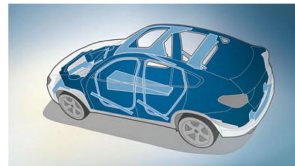
■ **Cellula abitacolo:** grazie alla sua struttura funzionale con speciale dislocazione degli elementi portanti e speciali collegamenti nodali, nonché all'impiego mirato di materiali ad alta resistenza, offre un grado ottimale di sicurezza passiva in caso di impatto frontale, laterale e posteriore.
