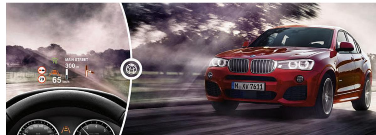
**La strada giusta è sempre sott'occhio.** Il BMW Head-Up Display<sup>2</sup> multicolorato (optional) proietta importanti informazioni per la guida direttamente nel campo visivo del conducente, che rimane più concentrato sulla strada. Vengono visualizzati per esempio la velocità attuale, le indicazioni di navigazione, la Speed Limit Info con indicazione dei divieti di sorpasso, la rubrica telefonica e gli elenchi dell'entertainment.
