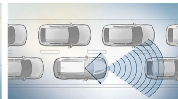
□ **Indicatore di pericolo di tamponamento<sup>1</sup>**, componente del Driving Assistant (optional): è una funzione di sicurezza basata su telecamere, che riconosce i veicoli che precedono e avverte il guidatore quando si avvicinano eccessivamente.
