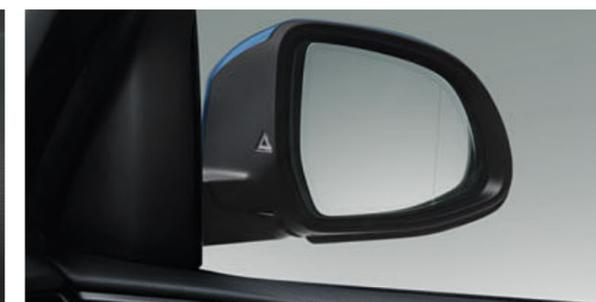
**Segnalatore di sorpasso pericoloso (Lane Change Warning):** segnala immediatamente al guidatore la presenza di altri veicoli, attraverso una vibrazione sul volante o un'indicazione ottica nel retrovisore esterno.
