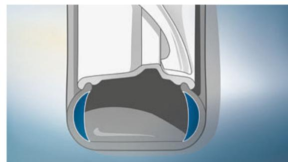
■ **L'indicatore di pressione dei pneumatici** mostra l'esatto livello di pressione in ogni momento e in caso di perdita avvisa automaticamente il conducente. I sensori presenti su ogni cerchio registrano i dati e li trasmettono all'unità di controllo con metodo wireless. In questo modo, l'indicatore di pressione pneumatici segnala sia le perdite rapide che le perdite più lente.
