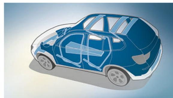
■ **Cellula abitacolo:** grazie alla sua struttura funzionale con speciale dislocazione degli elementi portanti e speciali collegamenti nodali, nonché all'impiego mirato di materiali ad alta resistenza, offre un grado ottimale di sicurezza passiva in caso di impatto frontale, laterale e posteriore.
