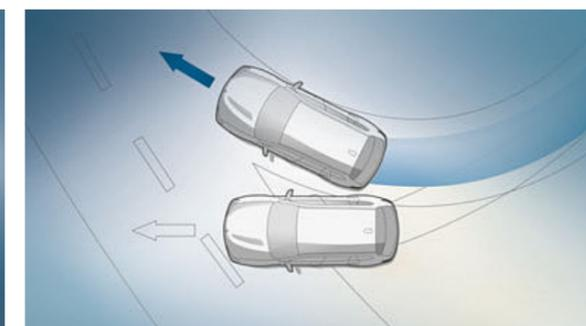
■ **Il Dynamic Stability Control (DSC)** con funzioni estese stabilizza l'auto, quando individua sul nascere un'eventuale tendenza al dérapage. Sono comprese le funzioni estese Cornering Brake Control (CBC), Automatic Hold, assistente di frenata, asciugatura dei freni e predisposizione alla frenata. La sottofunzione DTC (Dynamic Traction Control) consente un maggiore slittamento delle ruote, favorendo una guida più sportiva.
