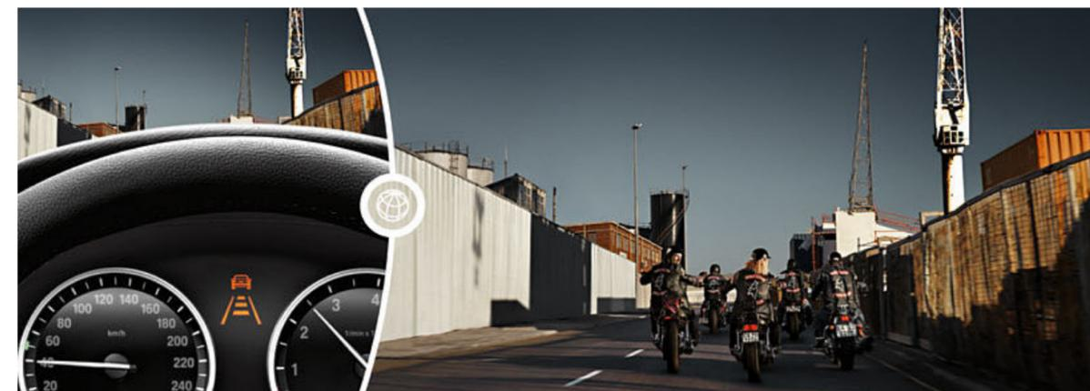
L'optional **Driving Assistant Plus** (disponibile solo con cambio automatico Steptronic) oltre all'Indicatore di pericolo di tamponamento e all'Avvisatore di cambio accidentale della corsia comprende anche l'Active Cruise Control con funzione Stop&Go. Così il Driving Assistant Plus aumenta sicurezza e comfort in ogni condizione di marcia.
