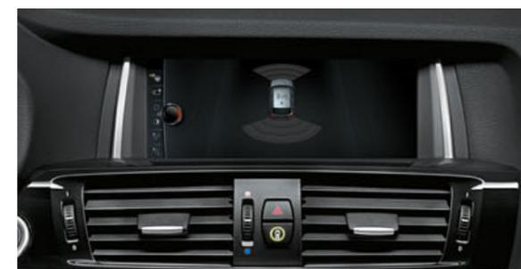
**Park Assistant:** facilita le manovre di parcheggio parallele alla corsia di marcia. A tale scopo il sistema misura gli spazi di parcheggio quando vi si passa accanto a velocità inferiori a 35 km/h. Se individua un parcheggio sufficientemente ampio, l'assistente esegue la manovra, coadiuvato dal guidatore che accelera o frena.
