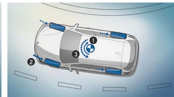
■ **Cornering Brake Control (CBC):** supporta il guidatore con una regolazione asimmetrica della pressione dei freni, quando viene effettuata una frenata in curva.
