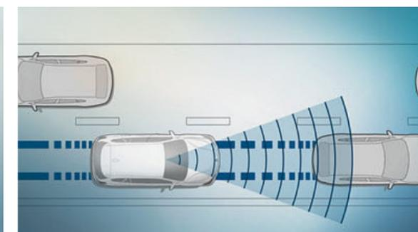
■ **Avviso di possibile tamponamento con funzione frenata City:** segnala al conducente il rischio di possibili collisioni, frenando automaticamente la vettura in caso di emergenza.<sup>2</sup>
