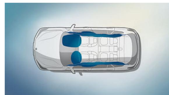
■ **Gli airbag per guidatore e passeggero** sono parte integrante del sistema di sicurezza BMW nel quale tutti i componenti sono armonizzati in modo ottimale. Complessivamente sono presenti sei airbag per la massima sicurezza. Sono gli airbag per il guidatore e il passeggero anteriore, gli airbag per la testa per le superfici dei finestrini laterali e gli airbag laterali negli schienali dei sedili anteriori.
