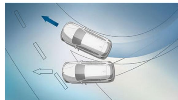
■ **Controllo dinamico di stabilità (DSC):** rileva costantemente lo stato attuale del veicolo e ottimizza la stabilità direzionale e la trazione.
