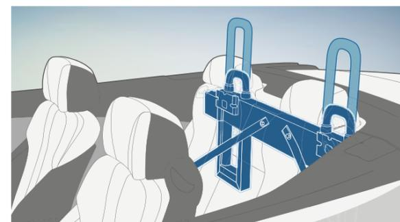
■ **Sistema di protezione antiribaltamento<sup>1</sup>**: comprende un rollbar integrato nel telaio del parabrezza e altri rollbar nascosti dietro i poggiatesta posteriori, che, in caso di ribaltamento, una molla fa scattare in alto in frazioni di secondo.
