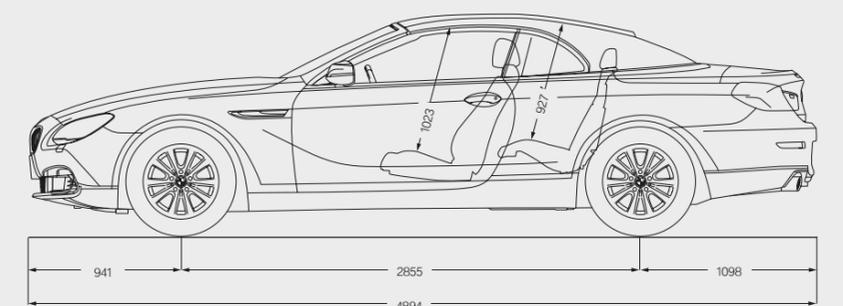
Tutte le misure dei disegni tecnici sono espresse in millimetri. I valori in parentesi si riferiscono alle vetture con tettuccio in vetro. Volume del vano bagagli di 460 litri per la Gran Coupé, 460 litri per la Coupé e 300 – 350 litri per la Cabrio (con alloggiamento capote sollevato).
