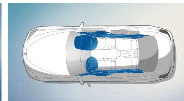
■ **Airbag per guidatore e passeggero**: sono parte integrante dei componenti di sicurezza di una BMW, adattati perfettamente in un sistema complessivo di estrema efficienza. Fino a sei airbag offrono ai passeggeri una protezione ottimale.
