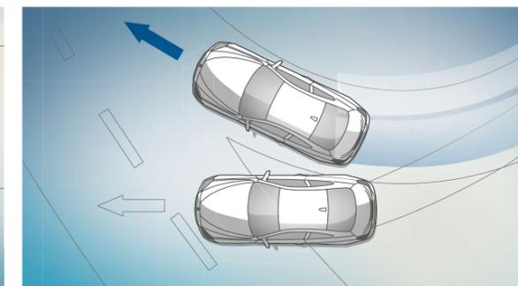
■ **Controllo dinamico della stabilità (DSC)**: rileva con continuità le condizioni di marcia della vettura tramite numerosi sensori e, alle prime avvisaglie di eventuale instabilità, stabilizza automaticamente l'auto intervenendo sulla gestione del motore e dell'impianto frenante.
