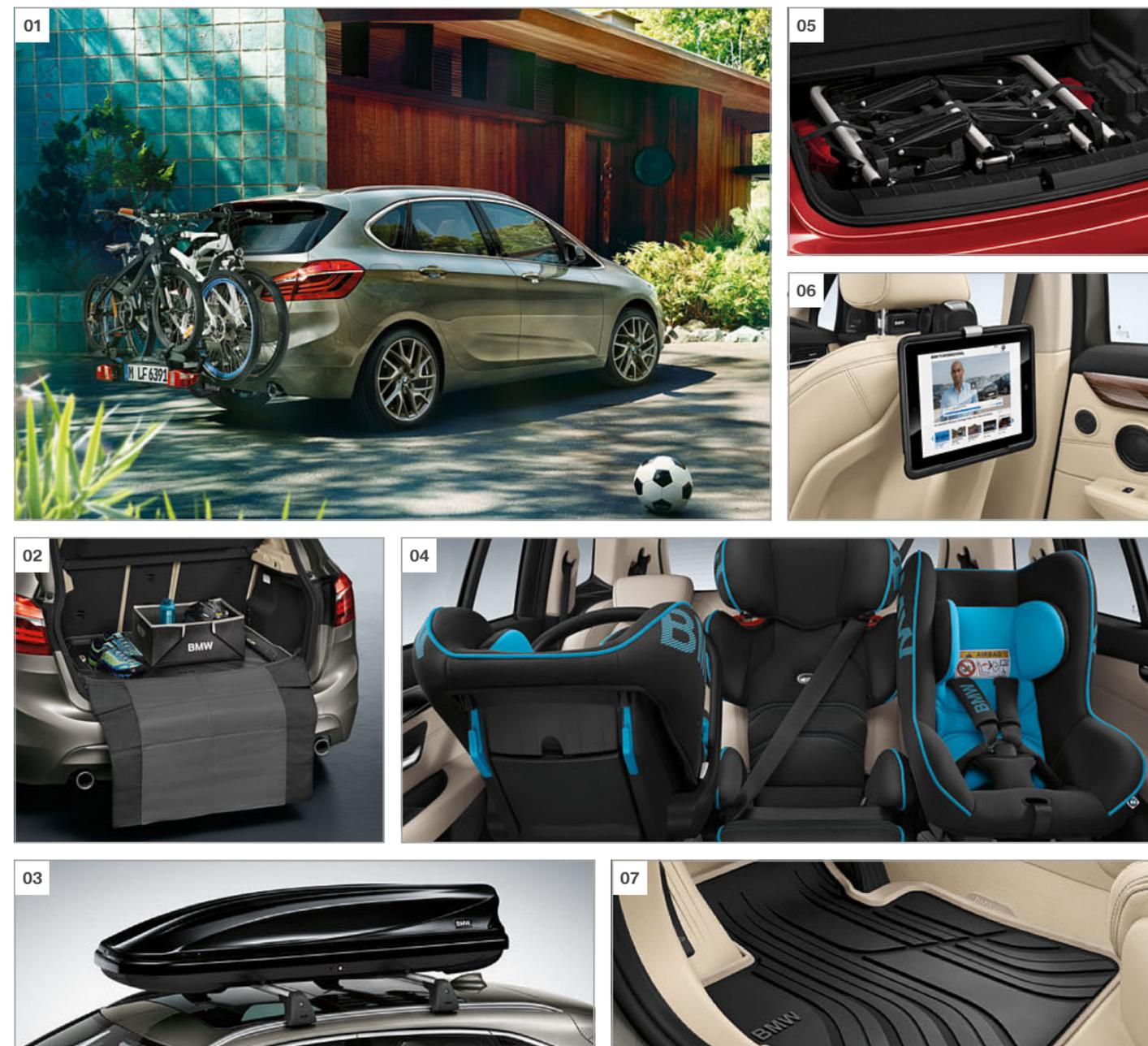
**[ 01 ]** Portabici per e-bike, adatto a trasportare fino a 3 bici elettriche (max. 60 kg); per la terza bicicletta è disponibile un apposito kit di estensione. Montaggio sicuro sul gancio di traino. Funzione di ribaltamento per facilitare l'accesso al bagagliaio.<sup>5</sup>
