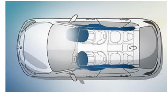
■ **Airbag lato guidatore e passeggero**, airbag per la testa e airbag laterali integrati negli schienali dei sedili anteriori: offrono una protezione mirata.
