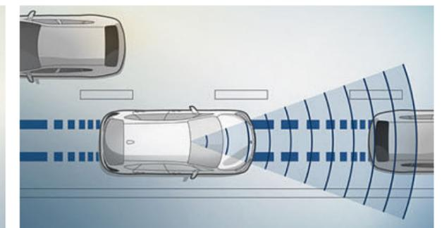
■ **Avvisatore di possibile tamponamento con funzione di frenata City**<sup>3</sup>: avvisa in caso di pericolo di collisione. Il sistema segnala il pericolo tramite un simbolo di avvertimento, frenando la vettura quando si viaggia a velocità inferiori a 60 km/h. In caso di emergenza, la vettura viene frenata automaticamente.
