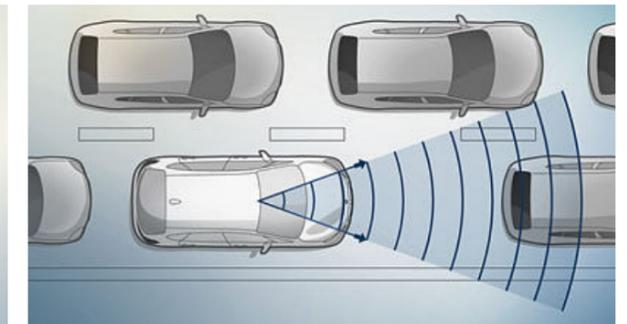
□ **Assistente di guida in colonna**<sup>2</sup>: sulle autostrade con traffico molto intenso, fino a 60 km/h regola automaticamente la velocità la distanza e la sterzata.
