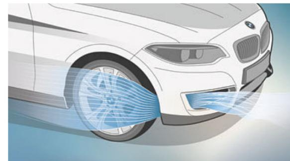
■ **Air Curtain:** canalizza l'aria sulla grembiatura anteriore e sulle ruote anteriori, riducendo così le turbolenze, la resistenza dell'aria e il consumo di carburante.
