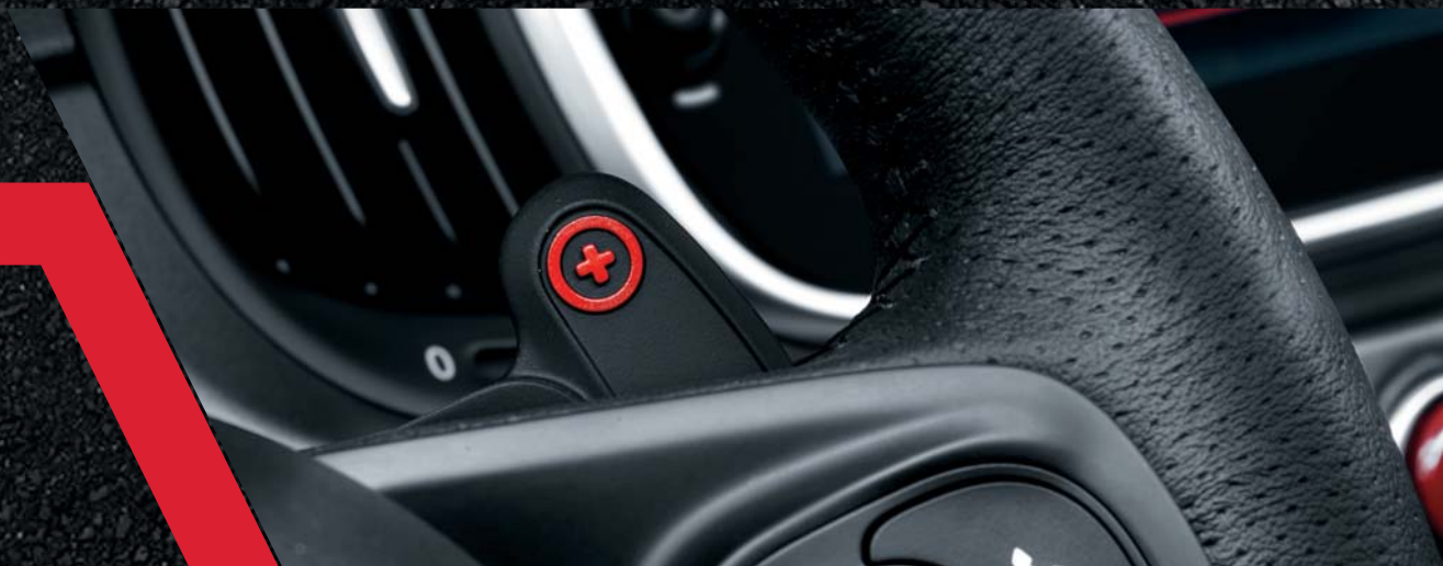
Cambio sequenziale robotizzato con palette al volante.
