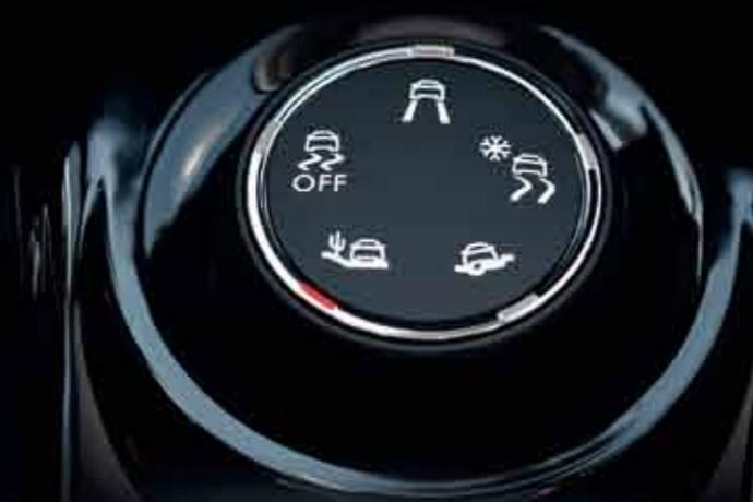
È il sistema che ottimizza la motricità in funzione della tipologia di terreno, agendo elettronicamente sull'ESP delle ruote anteriori. Disponibile sui motori superiori ai 100 CV, sia con cambio automatico che manuale, è associato a pneumatici da 17".
